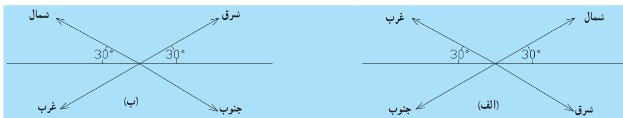
شکل ۷-۳- جهت‌های ایزومتریک در لوله‌کشی گاز
